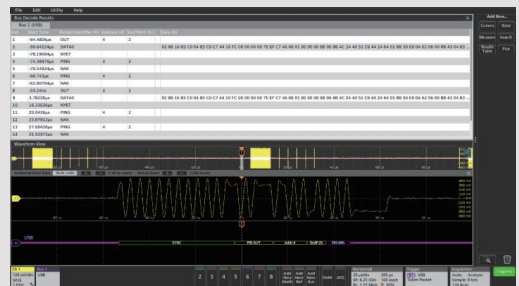
图九 USB2.0总线解码和触发搜索功能
